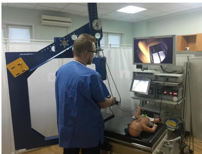
Рисунок 45 – Испытательный стенд. Тестирование балансировки манипулятора
